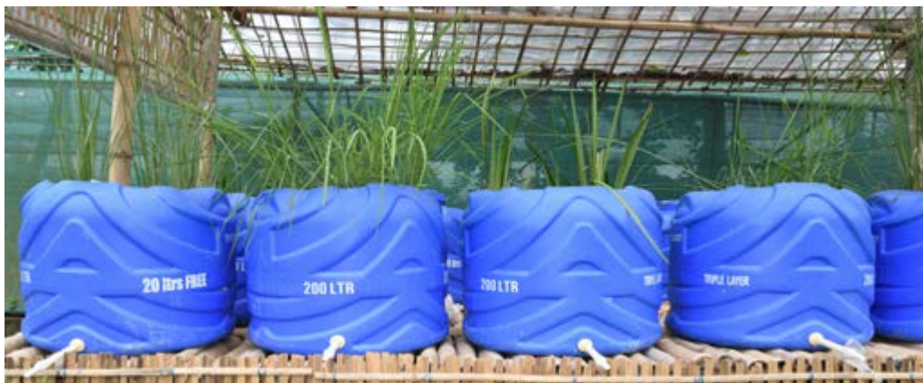
चित्र 8. विभिन्न आर्द्रभूमि मैक्रोफाइट्स के साथ प्रवाह को हटाने के निर्धारण के लिए प्रायोगिक सूक्ष्म जगत का अध्ययन
